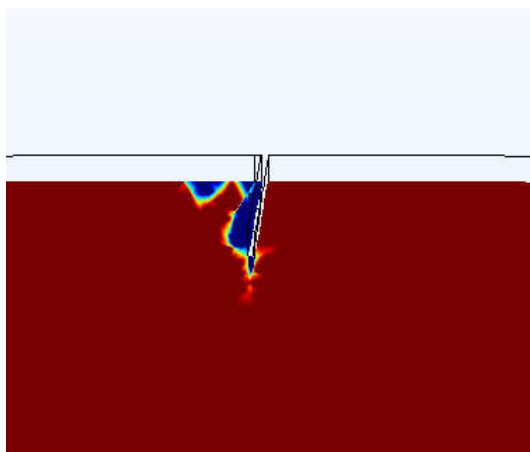
Рисунок 4.38 - Развитие трещины при наработке 2,33 млн. тонн брутто при наличии трещины на поверхности катания глубиной 1 мм
