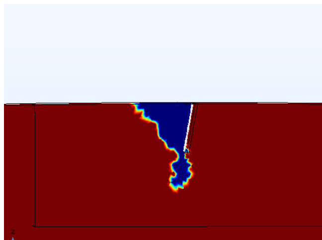
Рисунок 4.48 - Развитие трещины при наработке 697,5 млн. тонн брутто при наличии трещины на поверхности катания глубиной 2 мм
