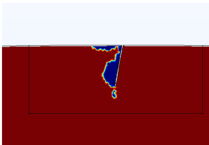
Рисунок 4.53 - Развитие трещины при наработке 2,1 млн. тонн брутто при наличии трещины на поверхности катания глубиной 3 мм
