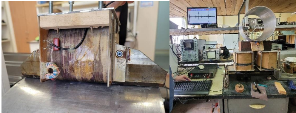
Рисунок 4.21 - Разработанный ЭМА-преобразователь рэлеевских волн на элементе алюминиевой трубы (а), лабораторный стенд системы подмагничивания (б)
