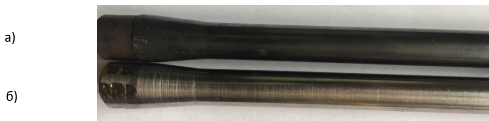
Рисунок 3.9 - Пруток с остаточной окалиной (а), пруток без остаточной окалины (б)
