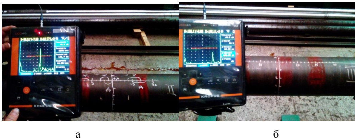
Рисунок 4.4 - Фото разметки, области сканирования и результатов УЗК дефектной зоны II образца №1 (а), дефектной зоны III образца №3 (б)
