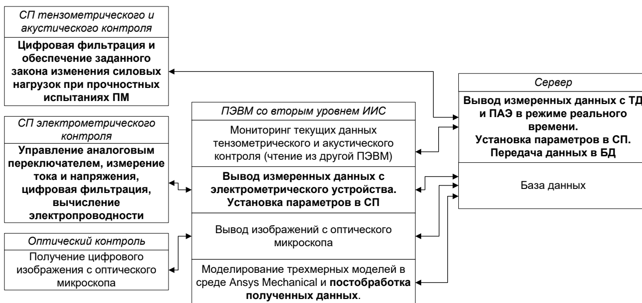
Рисунок 3.11 – Структурная схема ПО для комплексного исследования прочностных характеристик ПМ
