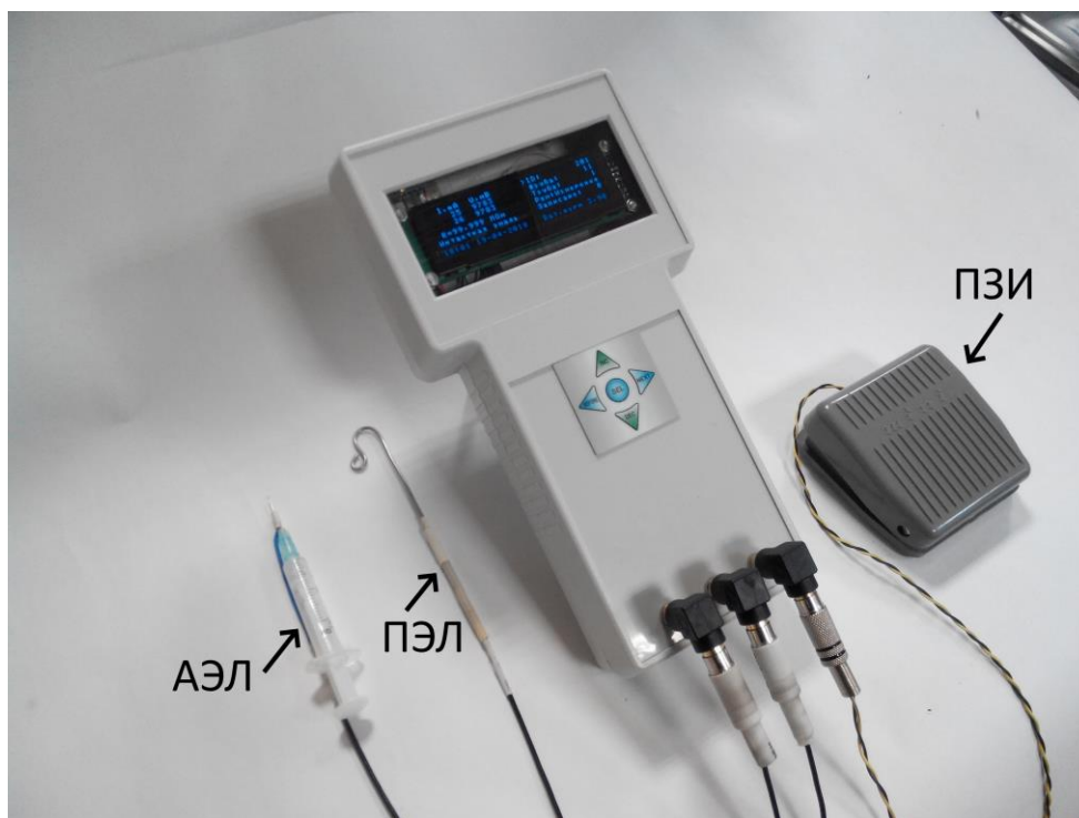
Рисунок 3.20 – Внешний вид ИЭУ (где АЭЛ – активный электрод; ПЭЛ – пассивный электрод; ПЗИ – педаль запуска измерений)
