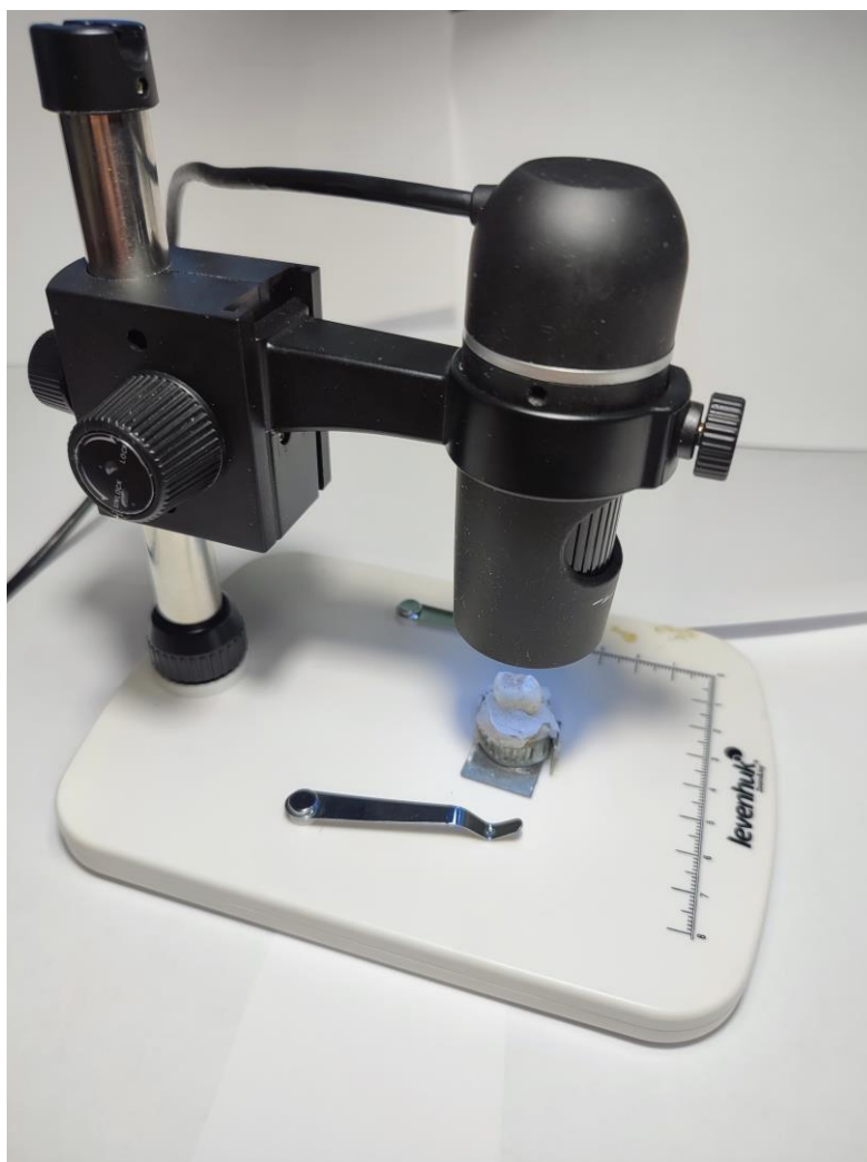
Рисунок 3.21 – Цифровой оптический микроскоп Levenhuk DTX90
