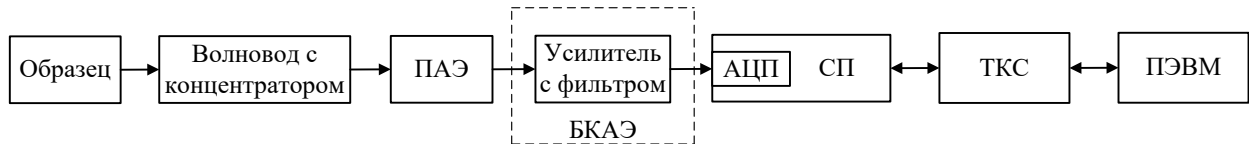
Рисунок 3.7 – Структурная схема подключения ПАЭ к ПЭВМ
