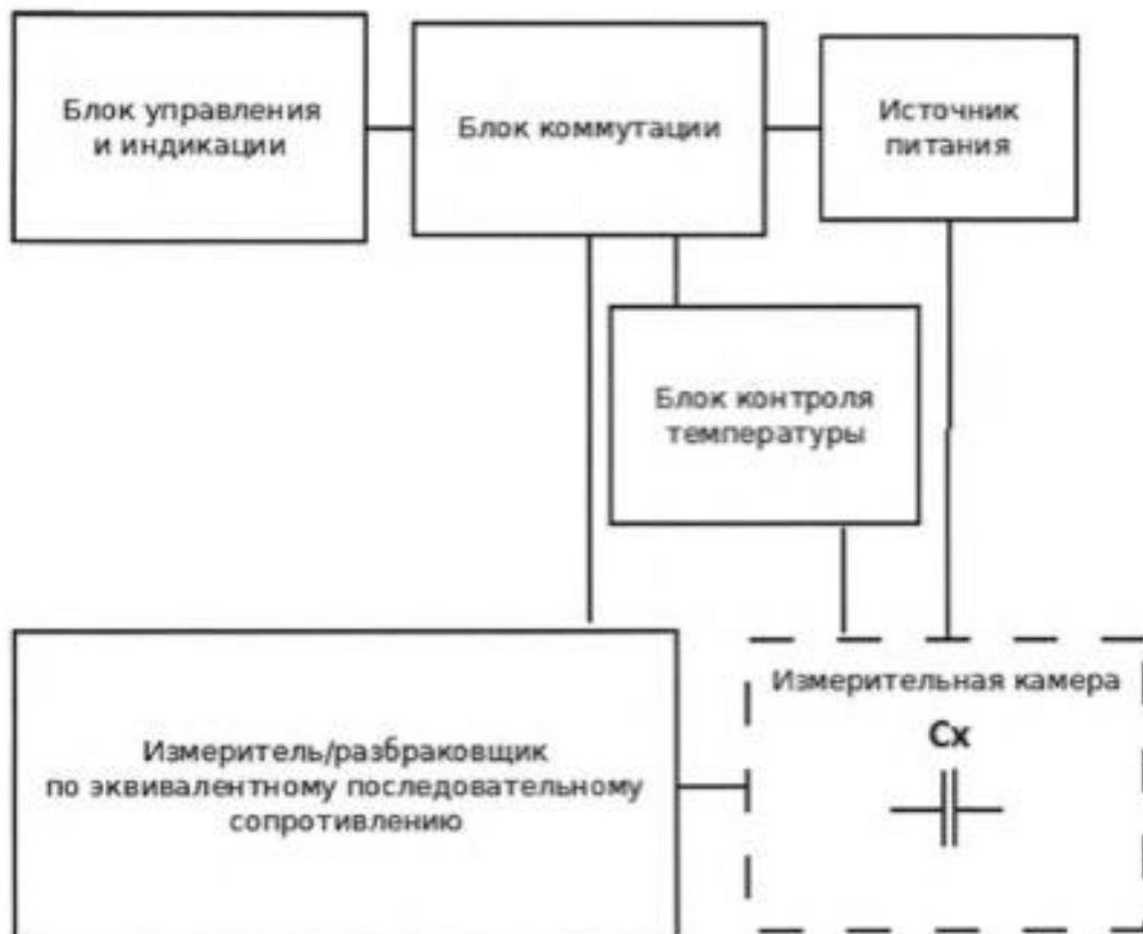
Рисунок 4.7 – Структурная схема установки разбраковки конденсаторов с применением СТРЕСС-ТЕСТА
