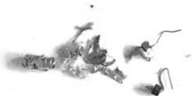
Рисунок 4.4 – Фотография разрушенного конденсатора
