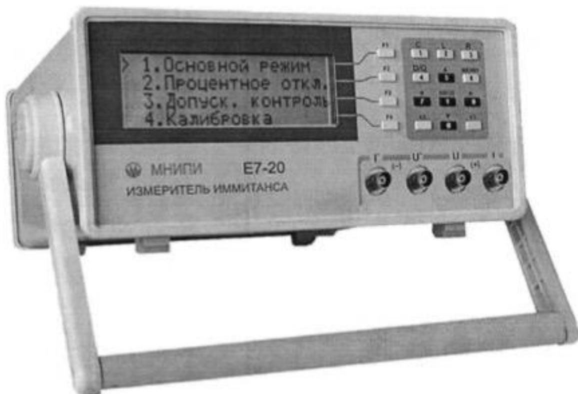
Рисунок 2.18 – Внешний вид измерителя иммитанса E7-20
