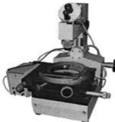
Рисунок 2.23 – Микроскоп инструментальный ИМЦЛ 150х50Б
