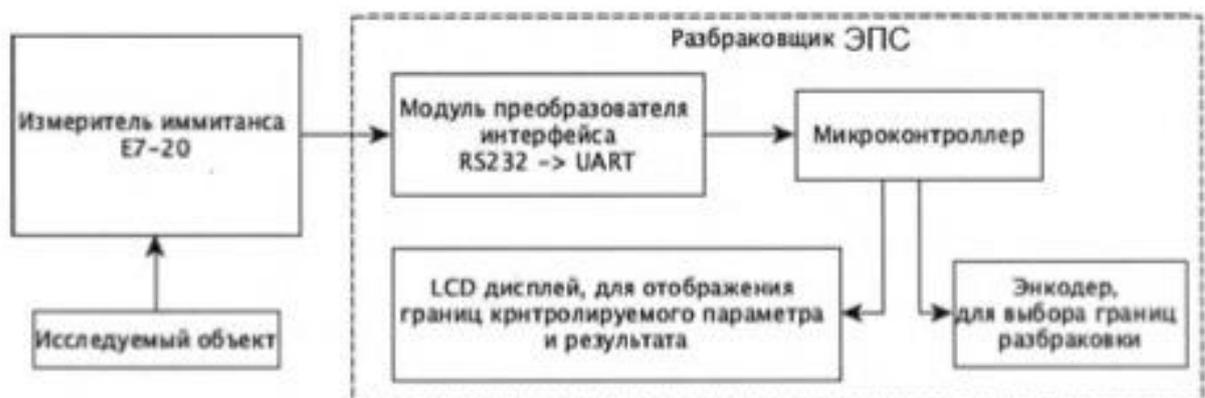
Рисунок 3.18 – Структурная схема ИРЭПС
