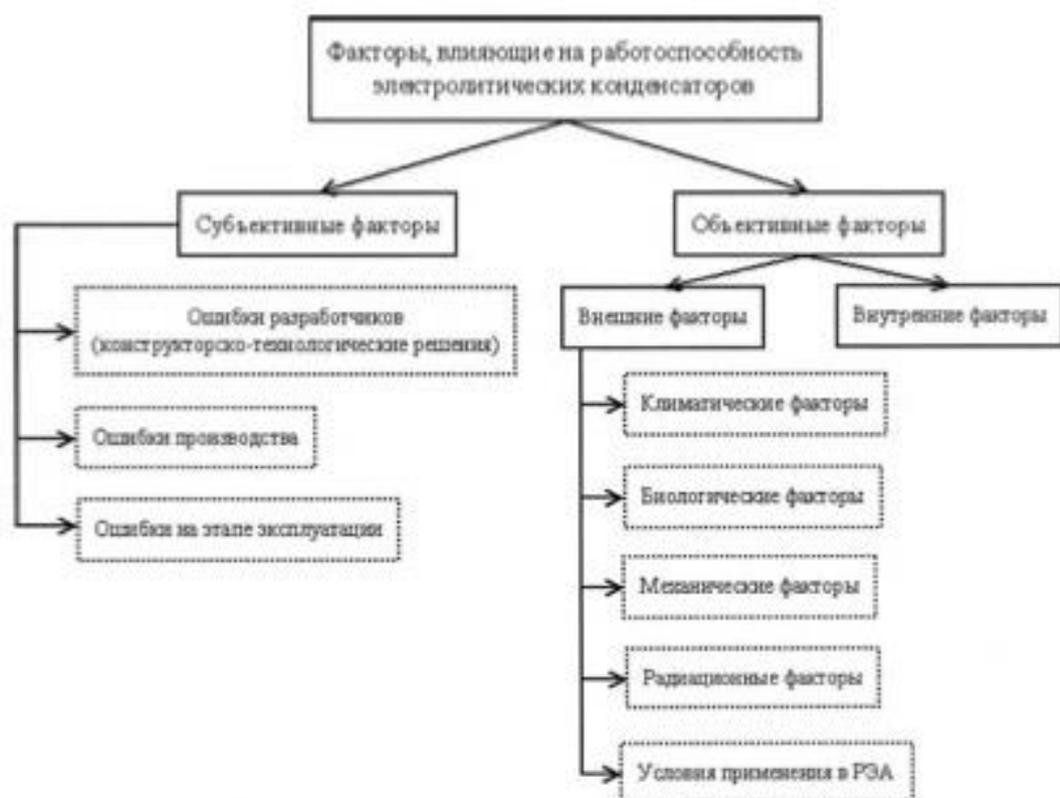
Рисунок 2.1 – Классификация факторов, влияющих на работоспособность электролитических конденсаторов и конденсаторов с ДЭС
