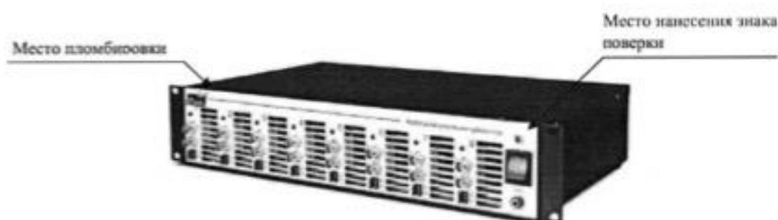
Рисунок 2.19 – Внешний вид потенциостата-гальваностата Р-20Х8
